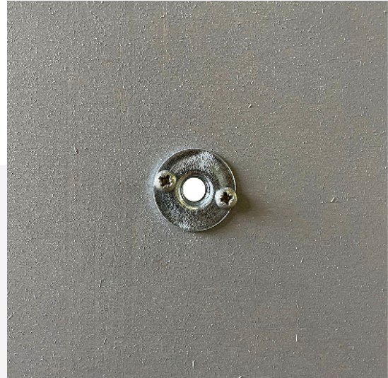
face arrière insérée + résinée
